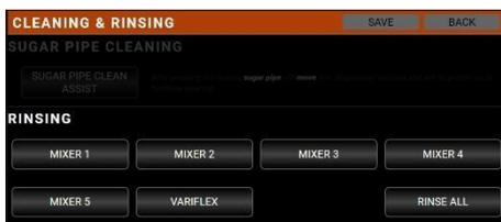
5. Pressione MISTURADOR 1, MISTURADOR 2, etc. para ativar o ciclo de enxágue do circuito hidráulico correspondente.
