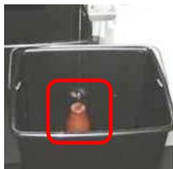
1. Coloque o balde de água residual (certifique-se de que os tubos de drenagem e o flutuador dentro dele estejam devidamente posicionados e que o flutuador possa se mover livremente).
